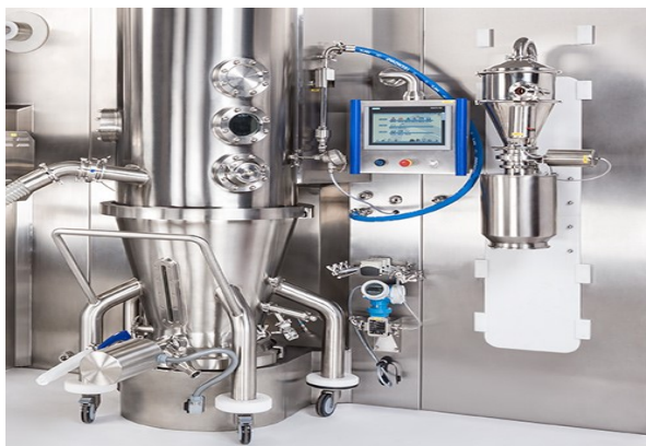
Рис. 5.9. Сушарка з киплячим (псевдозрідженим) шаром компанії STE [68]
