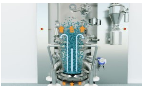
Рис. 5.10. Принципова схема сушарки з киплячим шаром [53, 68]
