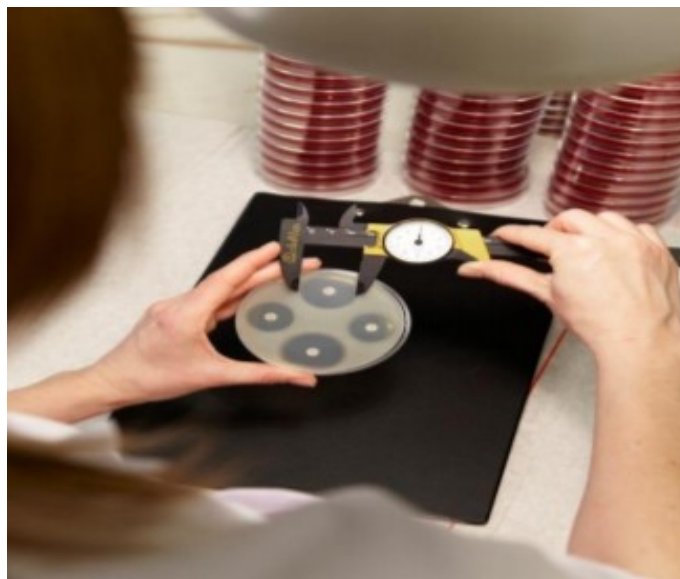
Рис. 9.8. Вимірювання зон пригнічення росту Staphylococcus aureus ATCC 29213 на чашках з МХА [79]
