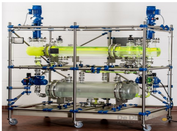
Рис. 5.7. Двохступеневий змішувально-відстійний екстрактор [64]
