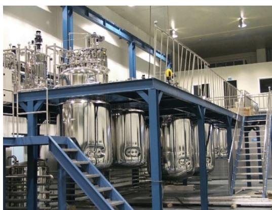
Рис. 5.1. Ферментер об'ємом 20 м 3 лінійки LiFlus SP [54]
