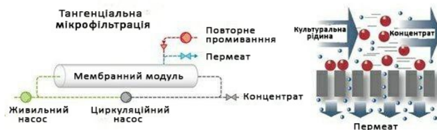
Рис. 5.2. Тангенціальна фільтрація на мікрофільтраційних модулях [9]
