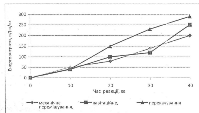
Рис. 4 – Витрати енергії на процес перемішування соєвої олії різними способами
