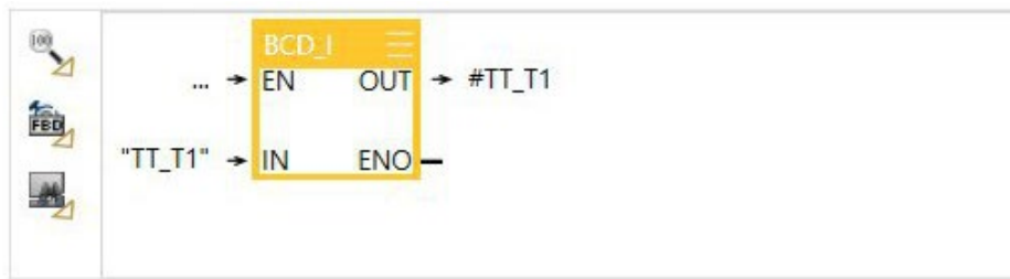
Рисунок 5.10 – Секція програми перетворення змінної температури в топці I формату WORD в INT.
