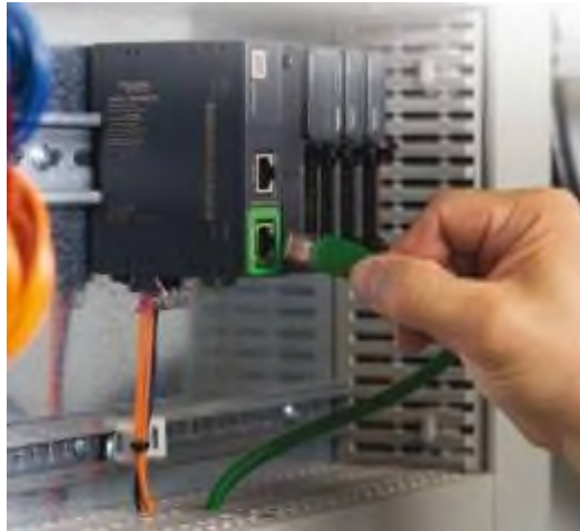
Рисунок 3.3- Зовнішній вигляд процесорного модуля M251
