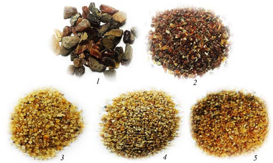
Рис. В.3. Зовнішній вигляд бурштину-сирцю та обробленого різними способами: 1 – бурштин-сирець; бурштин-сирець (1500 мкм); 3 – фракція (900 мкм) обробленого бурштину у спиртовому середовищі, 125 кДж; 4 – фракція 900 мкм обробленого бурштину у спиртовому середовищі, 250 кДж; 5 – фракція (900 мкм) обробленого бурштину у водному середовищі, 250 кДж
