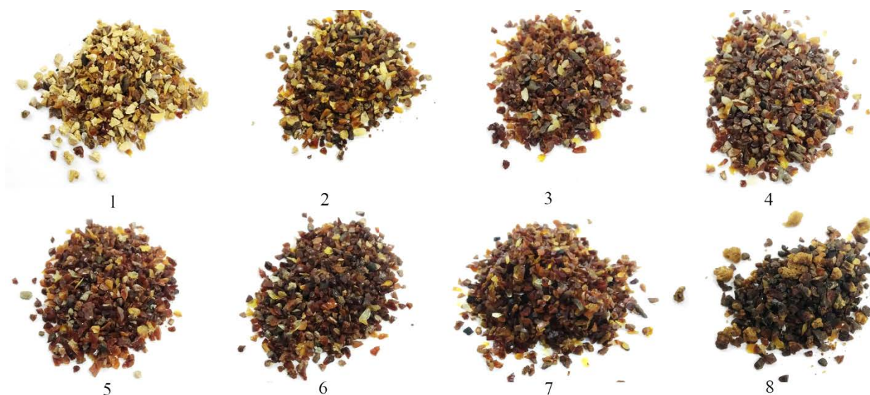
Рис. 3.3. Шрот після екстрагування з: 1 – водою; 2 – етанолом; 3 – гексаном; 4 – ацетоном; 5 – петролейним етером; 6 – уайт спіритом; 7 – гліцерином; 8 – гасом
