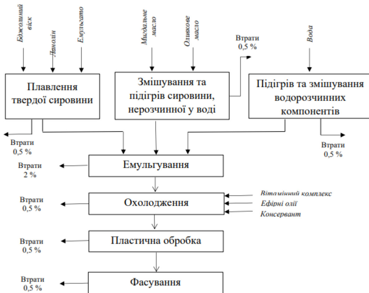
Рисунок 1.2. – Принципова схема виробництва емульсійних кремів [22]
