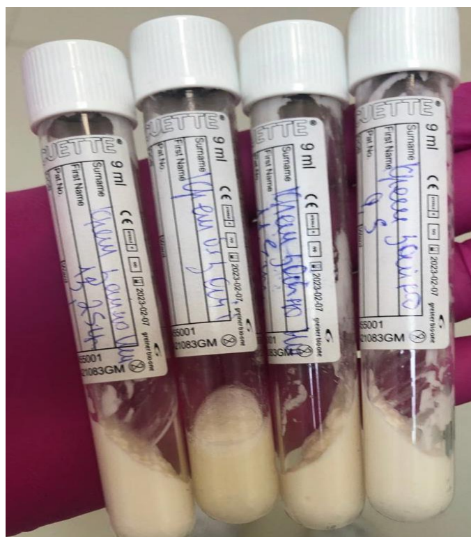
Рисунок 4.1 – Результати термостабільності зразків емульсійного крему з маслом Ши
