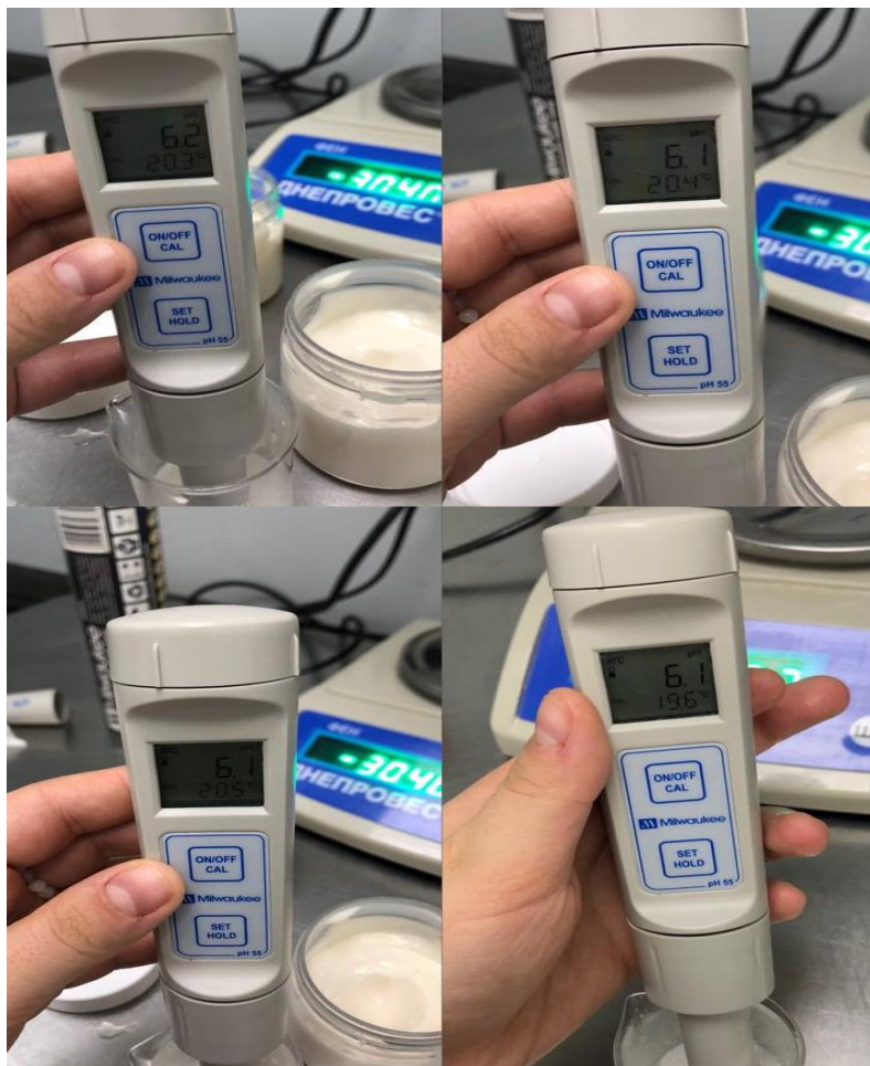
Рисунок 4.3 – Результати вимірювання значення рН емульсійного крему з маслом Ши
