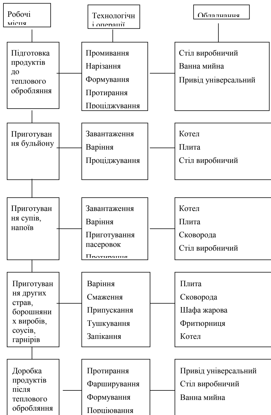
Рис.3.3 - Схема організації технологічного процесу у гарячому цеху
