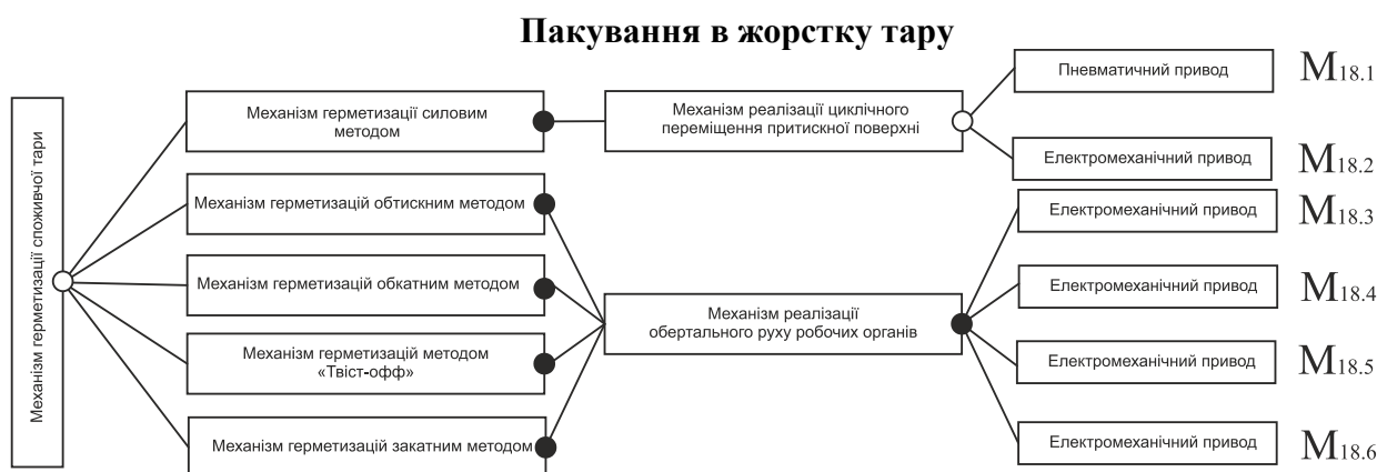
Рисунок 2 – Граф структури модуля герметизації поживної тари : ● – вершини зв’язані умовою «так»; ○ – вершини зв’язані умовою «або».
