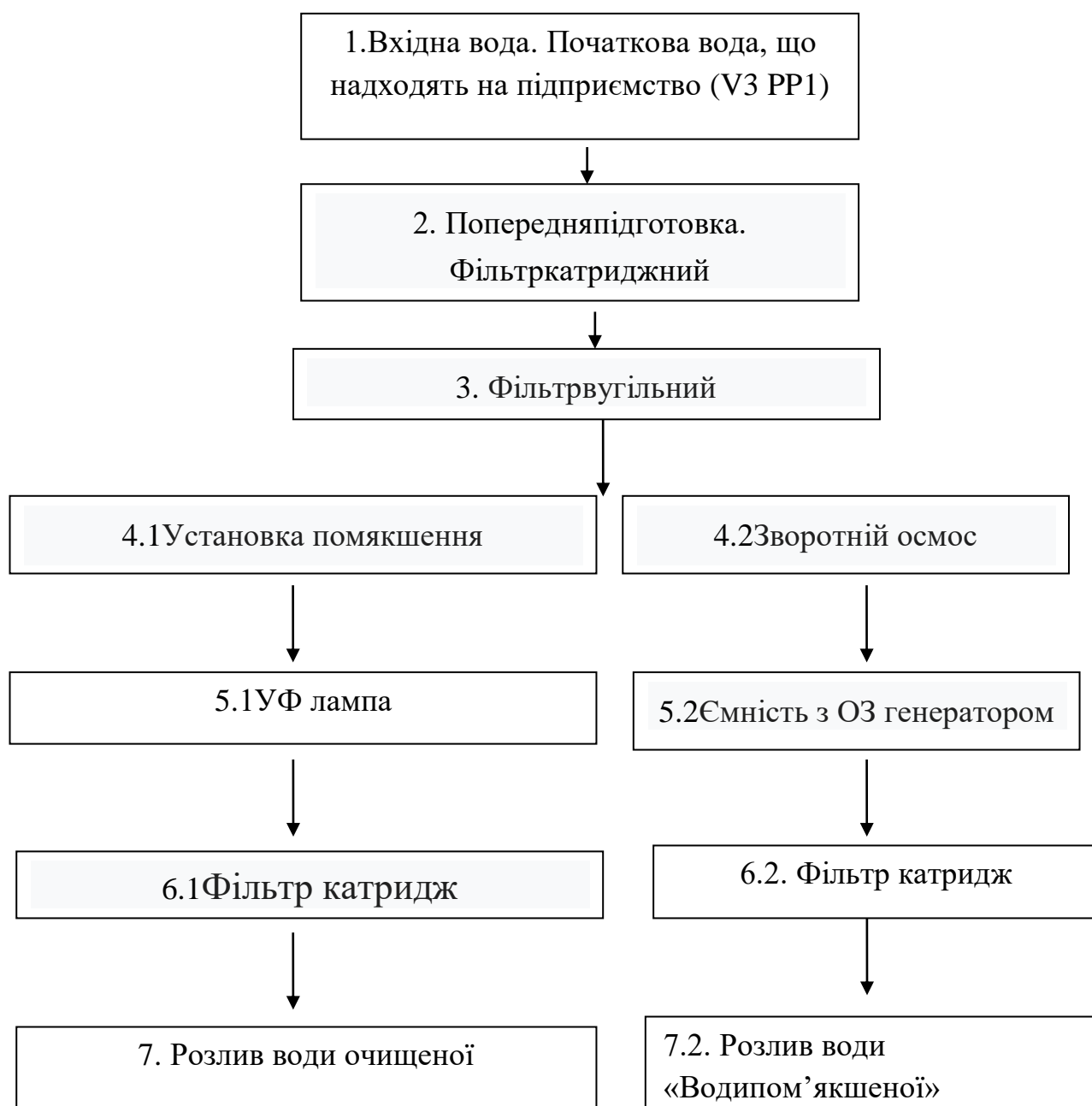
Рисунок 3.1. Схема процесу водопідготовки
