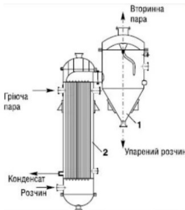
Рис. 1.2. Вакуум-випарний апарат з винесеною зоною нагріву:
