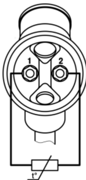
Рис. 4.3 Двопровідна схема підключення проводів до клем пластмасової комутаційної головки ДТС064-РТ100
