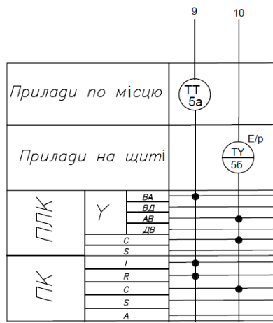
Рис. 3.2 Контур регулювання температури води у підігрівачі
