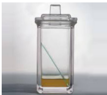
Рисунок 2.10 – Проведення тонкошарової хроматографії у камері
