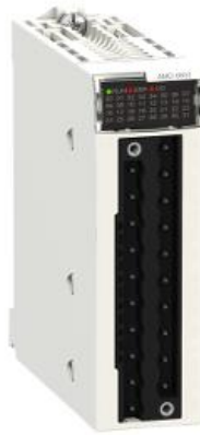
Рис.3.2. Зовнішній вигляд модуля аналогових виходів BMX АМО 0802.
