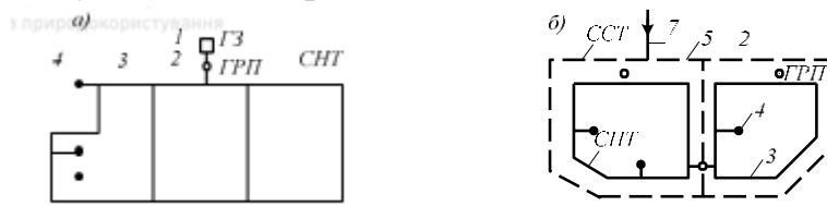
Рис. 9.3. Системи газопостачання населених пунктів: а – одноступінчаста; б – двоступінчаста
