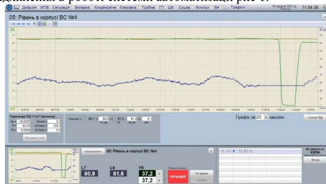
Рис 1. Відхилення в роботі системи автоматизації досліджуваної ділянки (— завдання, — значення технологічного параметру (рівень в апараті), — сигнал керування).
