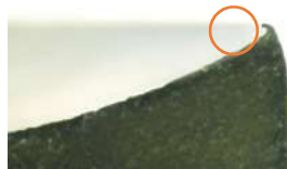
Рис. 2. Приклад утворення J подібних зачепів на кромці пуансона
