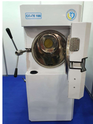
Інноваційний стерилізатор паровий СП-ГК 100
