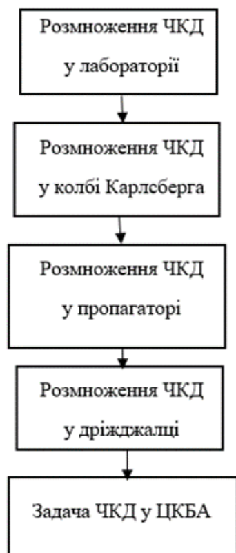
Рис. 2.2. Принципова схема розведення дріжджів в лабораторії
