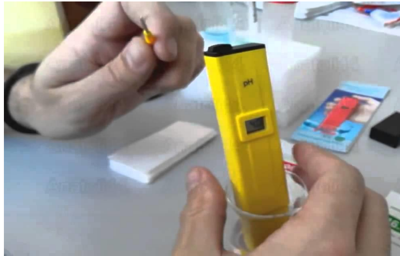
Рисунок 3.11 – Вимірювання активної кислотності зразків за допомогою портативного цифрового рН-метра РН-009
