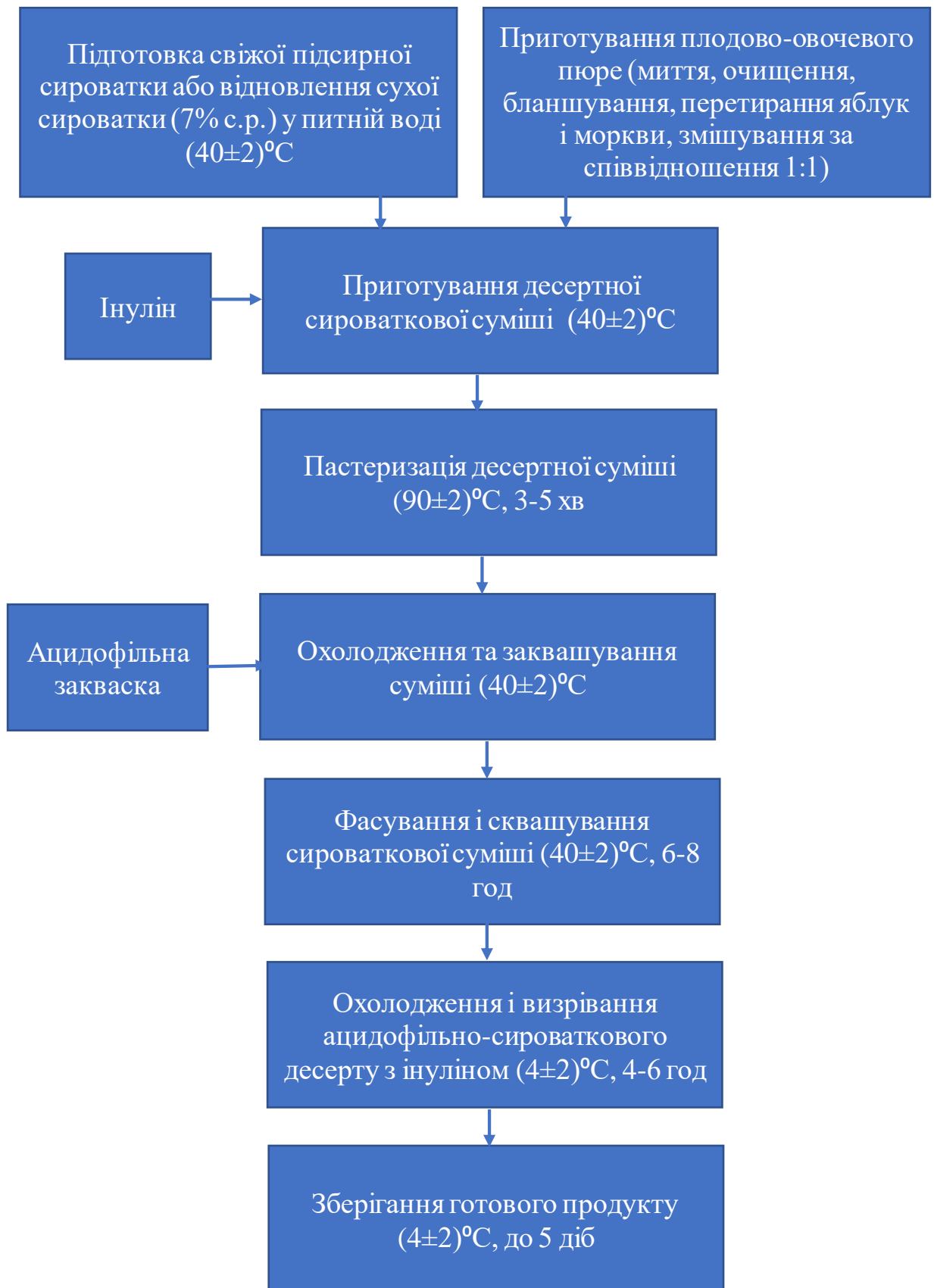
Рисунок 3.14 – Принципова технологічна схема виробництва ацидофільно-сироваткового десерту з плодово-овочевим пюре та інуліном
