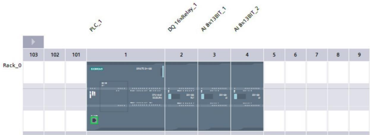
Рисунок 5.1- Конфігурація модулів контроллера.
