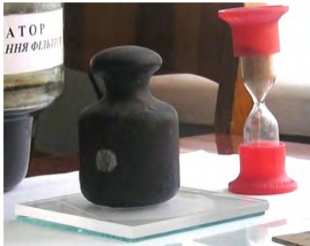
Рисунок 2.1 - Пресування наважки фаршу за методикою Р. Грау
