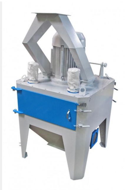
Фото 5. Молоткова дробарка з вертикальною віссю обертання (горизонтальний ротор)
