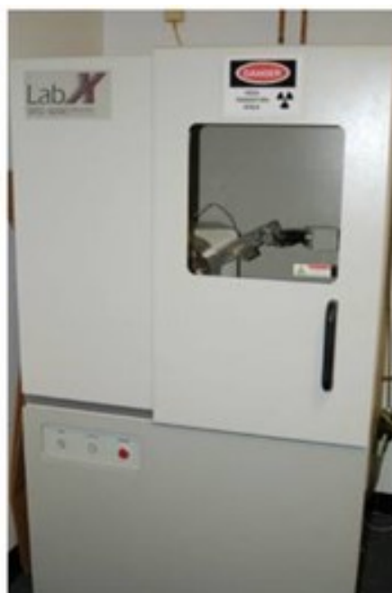
Рисунок 2.6 – Дифрактометр та його характеристики
