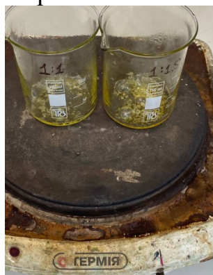
Рисунок 3.3 – Підготовка зразків із співвідношенням Zn:лимонна кислоти 1:1 та 1:1,5
