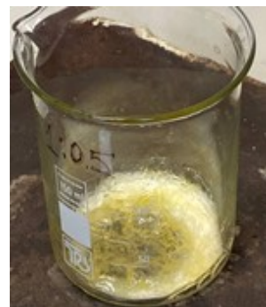
Рисунок 3.1 – Підготовка зразку із співвідношенням Zn:лимонна кислота 1:0,5. Відбір реактивів (а), утворення гелю (б), утворення ксерогелю (в)
