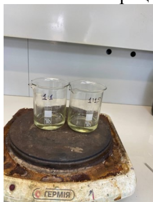
Рисунок 3.3 – Підготовка зразків із співвідношенням Zn:лимонна кислоти 1:1 та 1:1,5
