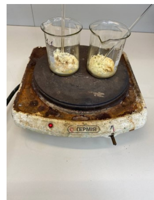
Рисунок 3.3 – Підготовка зразків із співвідношенням Zn:лимонна кислоти 1:1 та 1:1,5
