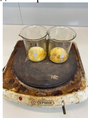
Рисунок 3.3 – Підготовка зразків із співвідношенням Zn:лимонна кислоти 1:1 та 1:1,5
