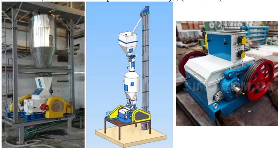
Рис. 3.7. Конструкція плющильного станку ПС-400 виробництва ТОВ Агро-Сімо-Машбуд (м. Одеса)
