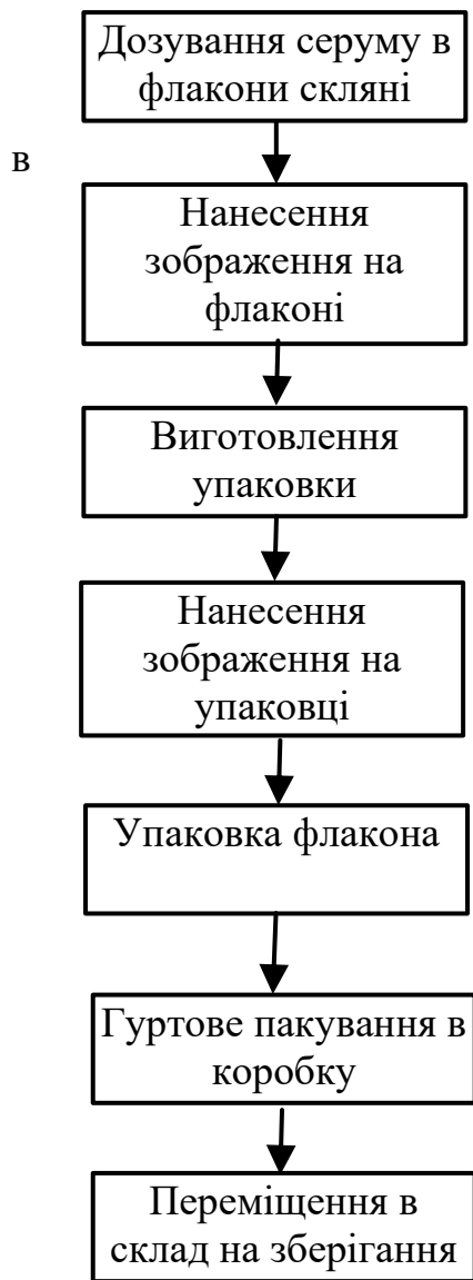
Рис.4.10 – Алгоритм технологічних процесів лінії пакування сироватки
