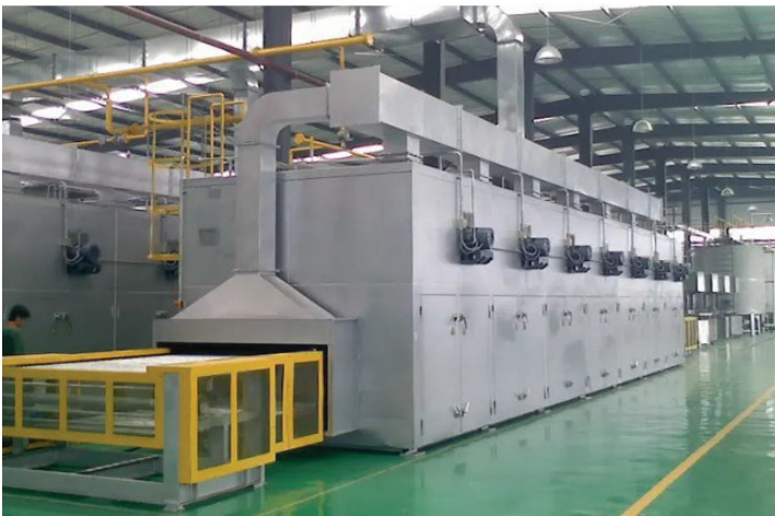
Рис.2.6. Система сушки формованих лотків
