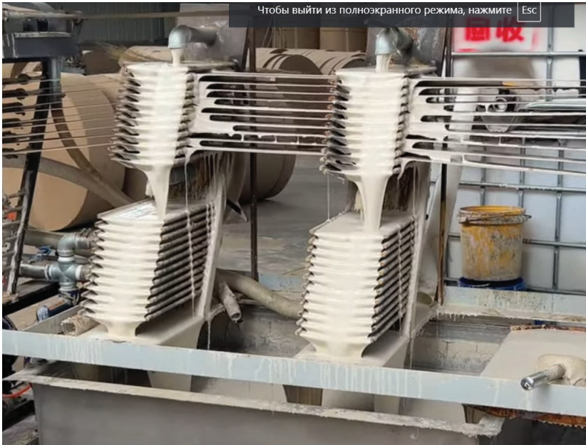
Рис.3.4. Операція нанесення клею на стрічки паперу
