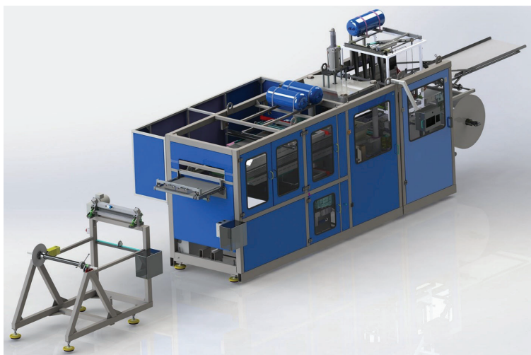
Рис. 10.15. Загальний вигляд пневмоформувальної машини для рулонних матеріалів
