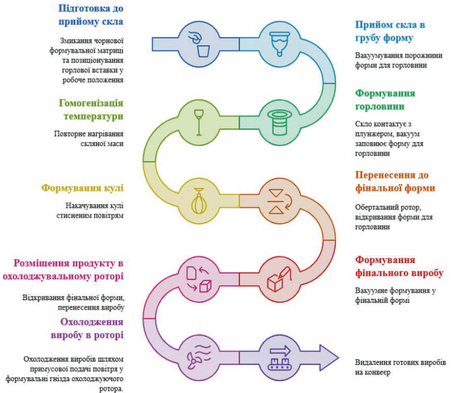
Рис.14.8. Схема процесу автоматизації формування скляних виробів
