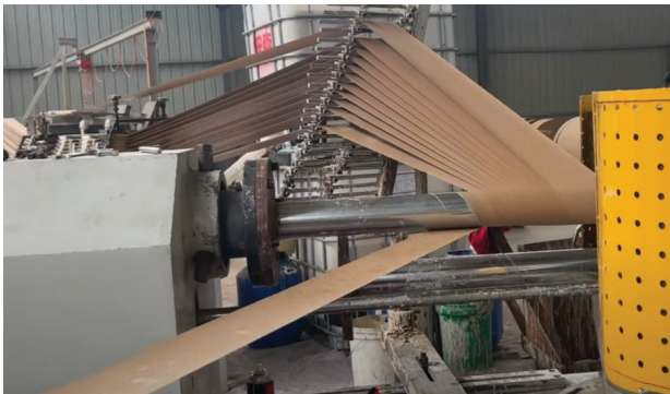
Рис.3.3. Операція намотування стрічок паперу на оправку
