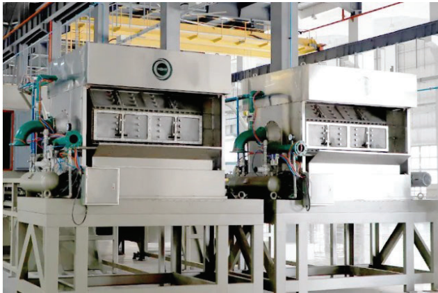
Рис.2.9. Роторна система формування заготовок лотків
