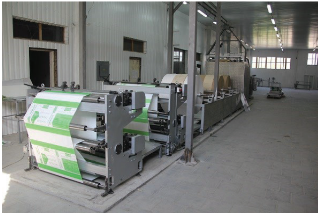
Рис.2.27. Загальний вид машини для виготовлення багатошарових мішків
