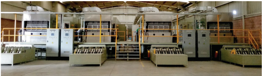
Рис.2.8. Загальний вигляд роторної машини для виготовлення лотків для яєць
