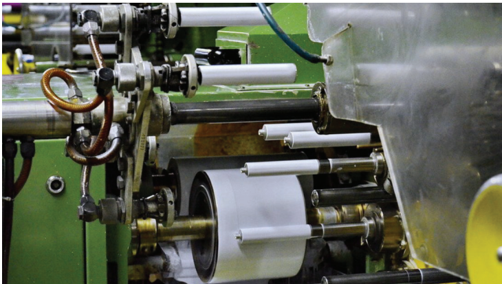
Рис.11.7. Нанесення фарби на зовнішню поверхню туби
