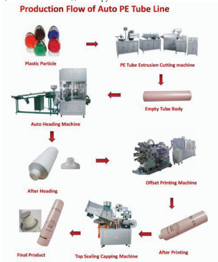
Рис.11.10. Технологічний процес виготовлення безшовних пластикових туб
