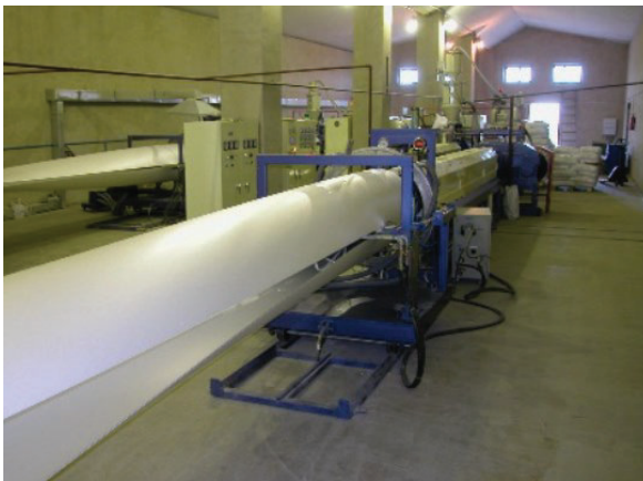
Рис. 7.11. Екструдер для виробництва листів пінополістиролу
