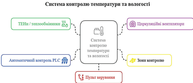
Рис.20.4. Загальна схема технологічного контролю сушіння піддонів
