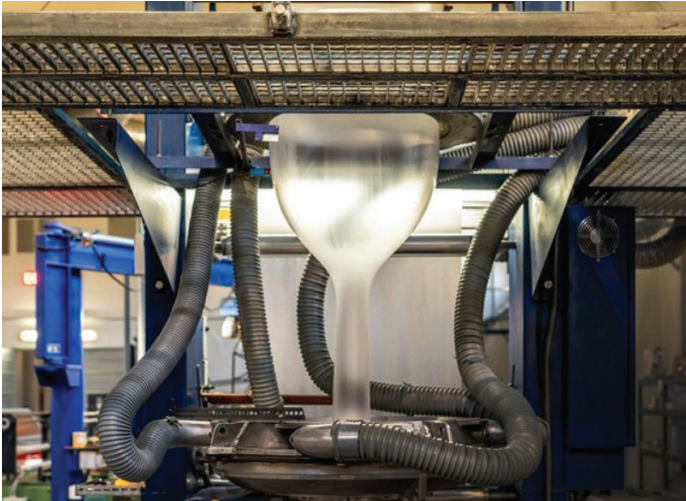
Рис.10.17. Екструдер для виготовлення плівки
