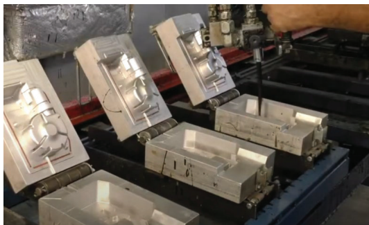
Рис. 7.8. Процес наповнення форм піно матеріалом
