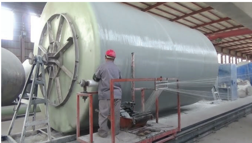
Рис. 9.11. Виробництво цистерни методом намотування полімерної нитки
