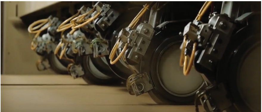
Рис.4.11. Поздовжня різка гофрованого картону
