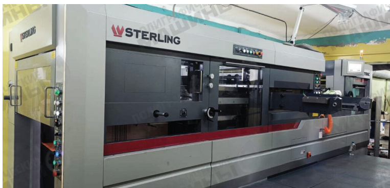
Рис. 5.4. Плоско-штанцювальна машина STERLING S-CUT 106
