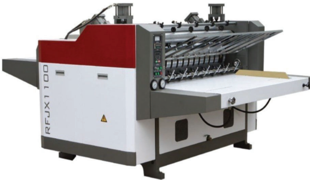
Рис. 5.7. Напівавтоматична каширувальна машина
