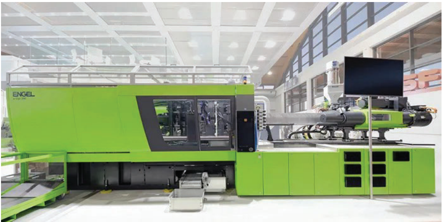
Рис.11.14. Термопластавтомат для виготовлення бушонів
