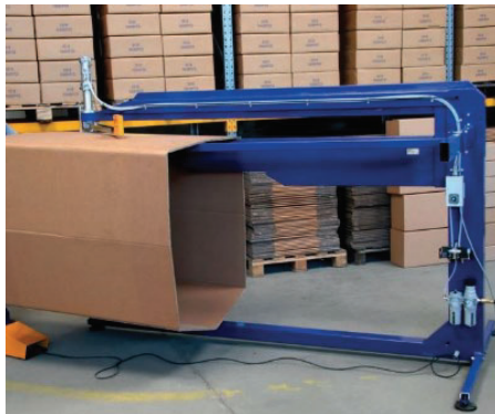
Рис. 2.23. Дротошвейна машина стаціонарнп для коробів великого розміру
