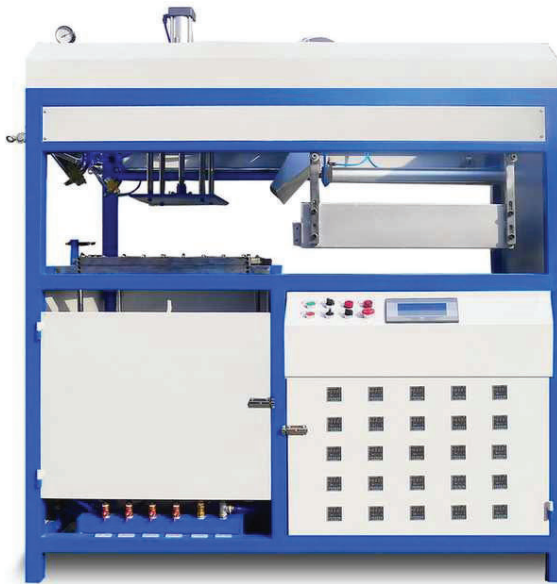
Рис. 10.4. Однопозиційна вакуум-формуюча машина із попереднім розтягуванням заготовки
