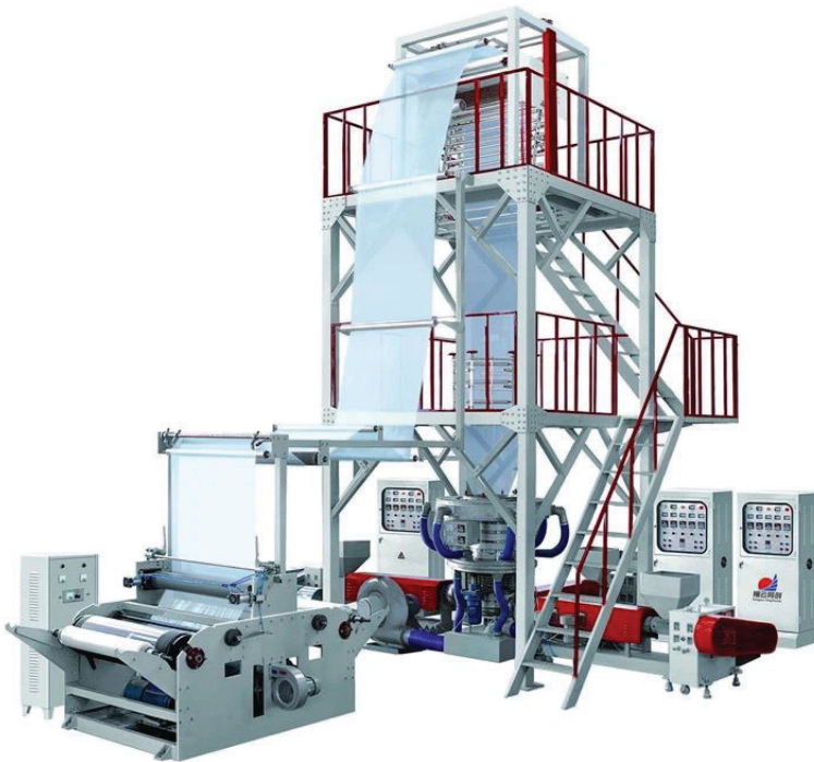
Рис.8.6. Екструдер для виготовлення рукавних плівок
