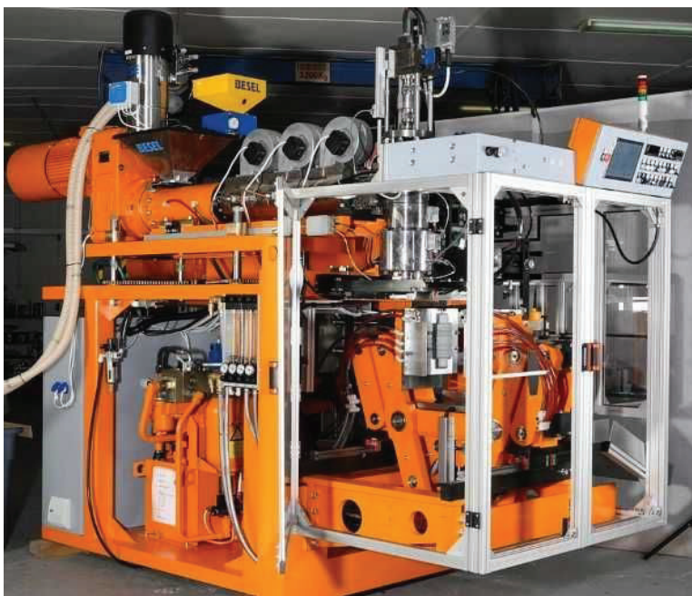
Рис. 9.8. Екструзійно-роздувальна машина для виробництва пластикових каністр
