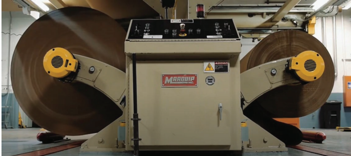
Рис.4.5. Секція встановлення рулонів гофрувального агрегату
