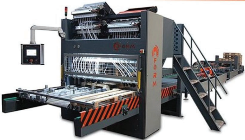
Рис. 20.1. Автоматичний гідравлічний верстат для збирання піддонів типу РСМ (виробництво Form, Туреччина)
