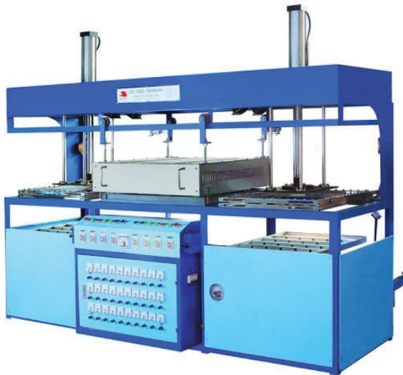
Рис.10.5. Двопозиційна вакуум-формуюча машина із попереднім розтягуванням заготовки
