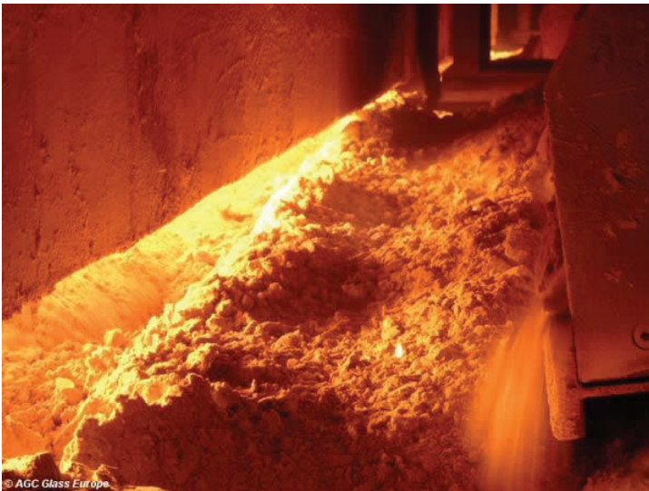
Рис.13.5. Завантаження шихти в скловарну піч
