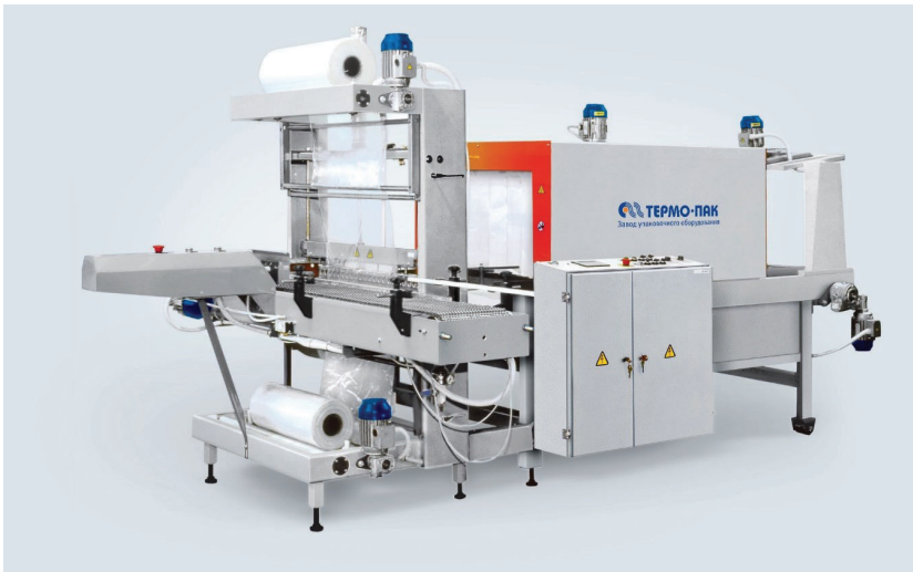
Рис.16.4. Термоусаджувальна машина тунельного типу
