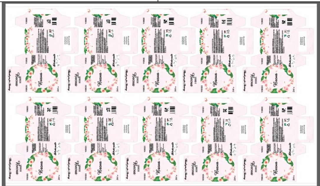
Рис.4.1 Розташування розгортки на аркуші 2200 мм x 1300 мм
