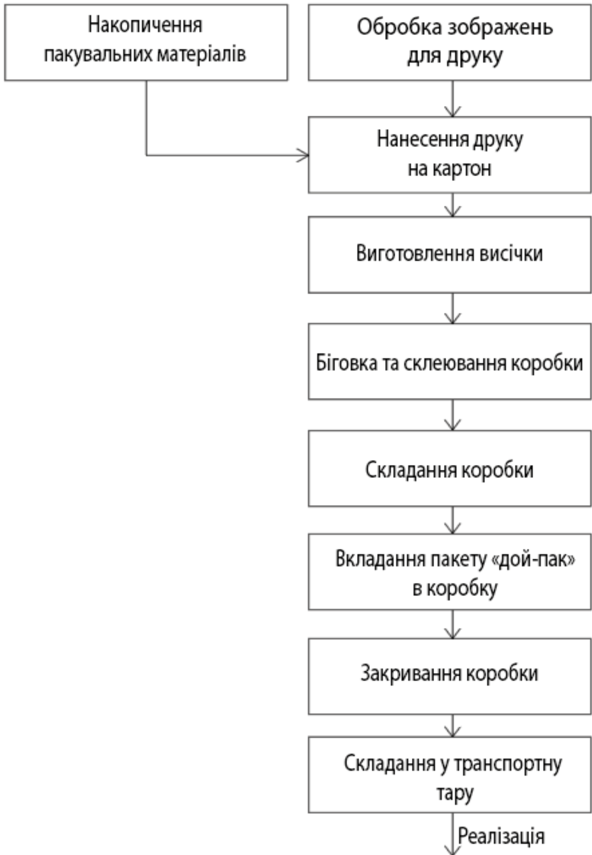
Рис.4.7 Спрощена блок-схема технологічного процесу
