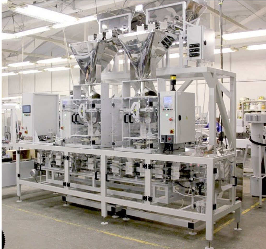
Рис.4.7 – Лінія для фасування сипучих продуктів в пакети і потім в коробку
