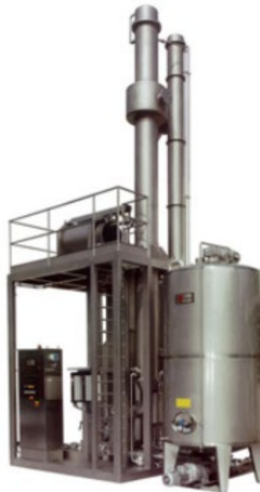
Рис. 2.6 – Схема термовініфікатора поточного типу «Ред Хантер». Загальний вигляд
