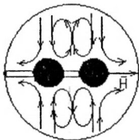
Рис.7. Направления потоков разбавленной кислоты H_2SO_4 с pH = 1,2 в окрестности двух ферромагнитных шариков диаметром порядка 500 мкм, приклеенных на медную проволоку в два раза меньшего диаметра и помещенных во внешнее постоянное магнитное поле 80 кА/м
