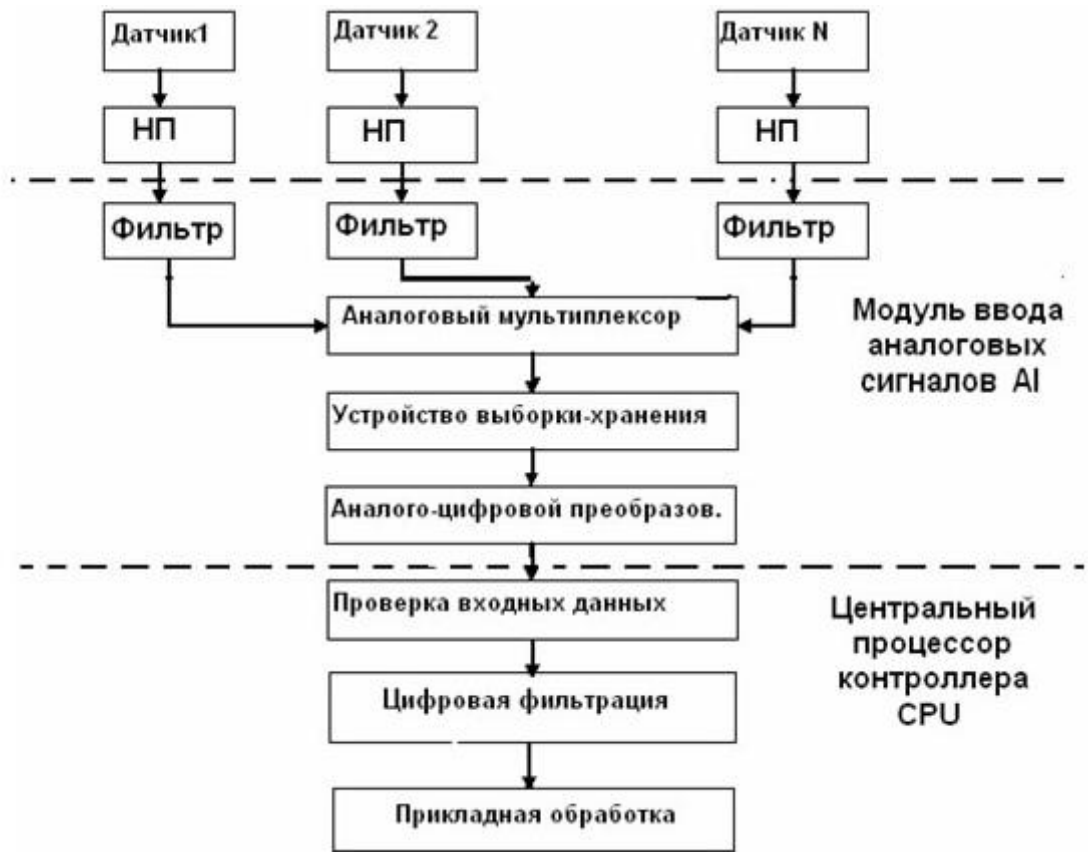
Рис.1.9 Схема обробки аналогового сигналу при введенні в контролер
