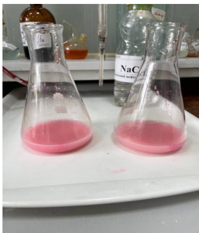
Рис 2.12 – Процес визначення активної кислотності методом титрування
