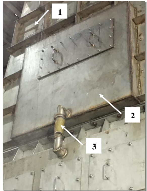
Рис. 4.4 – Завантажувальна шахта преса глибокого віджиму «Mercier» свіжого жому:
