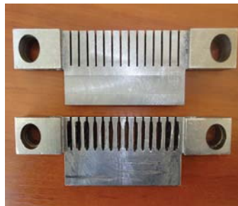
Фото 2. Нова (матеріал — сталь 40X13 (DIN X38Cr 13) після 300 годин експлуатації та спрацьована напрямна рамки шпигорізки
