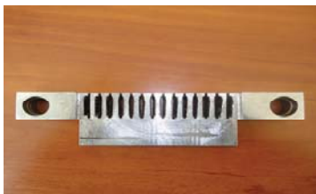
Фото 1. Направні рамки шпигорізки після 1000 годин експлуатації
