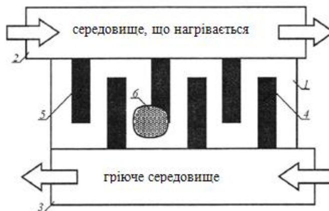
Рис. 11.2. Конструкція теплового акумулятора з тепловими трубами:
