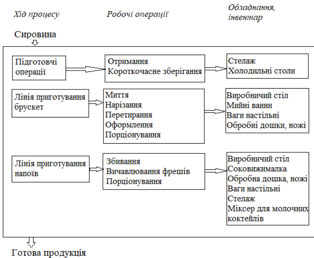
Рисунок 3.4.1 - Структурно-технологічна схема виробничого процесу холодного цеху
