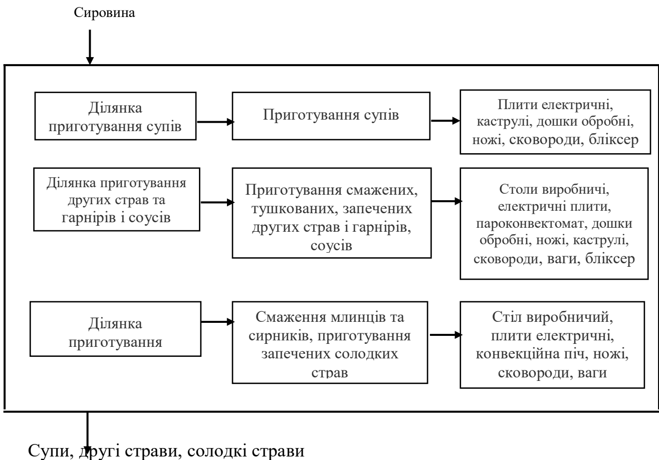
Рис.3.5 – Структурно-технологічна схема організації виробничого процесу в гарячому цеху
