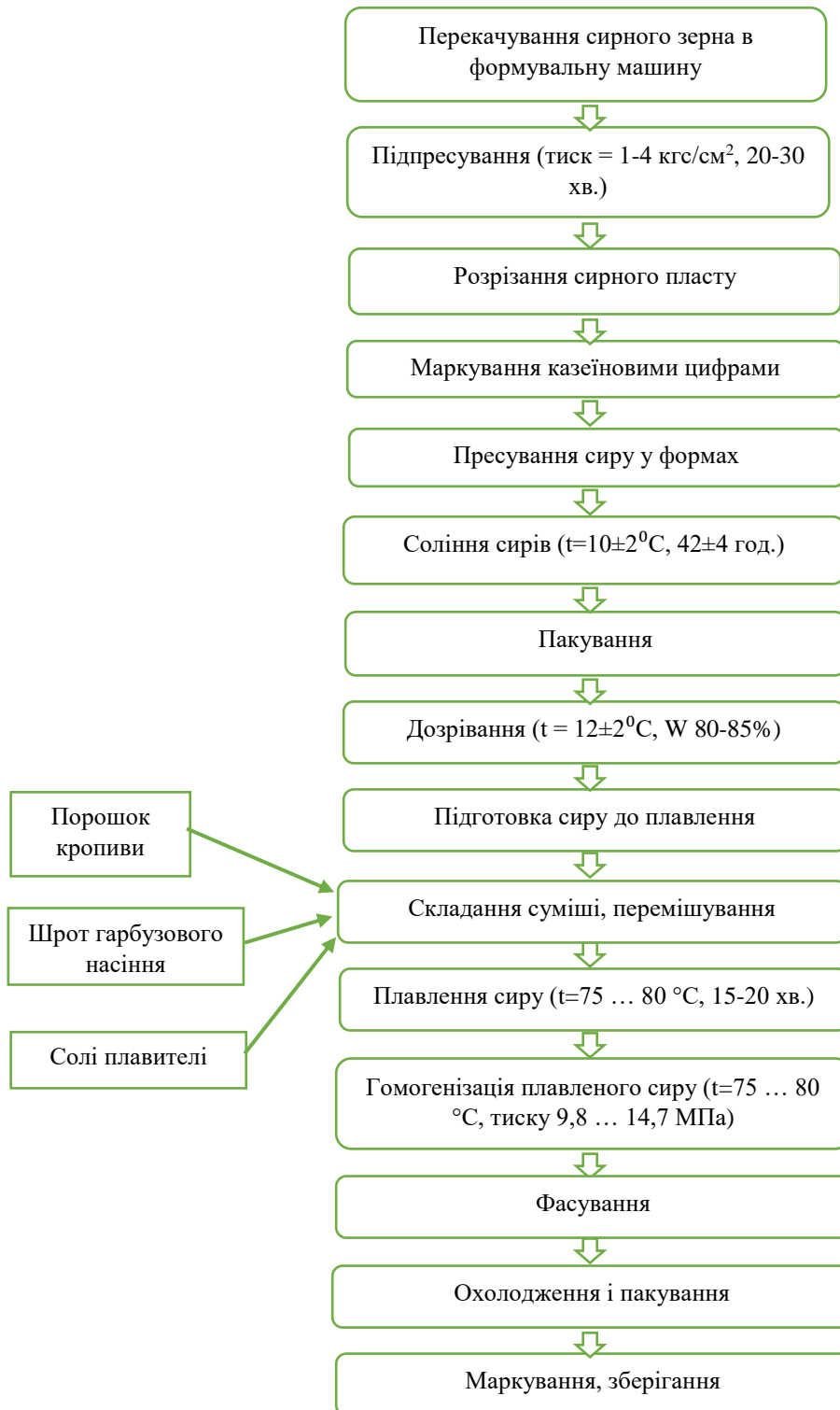
Рисунок 2.1. « Принципово-технологічна схема виготовлення плавленого сиру, збагаченого шротом гарбузового насіння та порошком кропиви»
