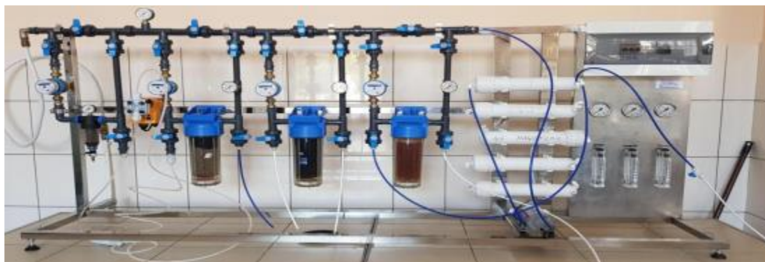
Рис 3.1 Фото зворотноосмотичної установки
