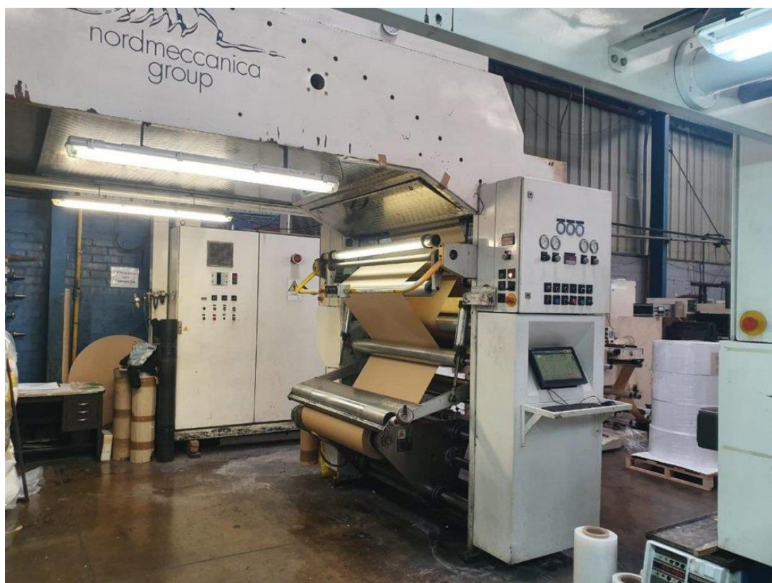
Рис.4.3. Ламінатор SUPER COMBI 2000, Nordmeccanica
