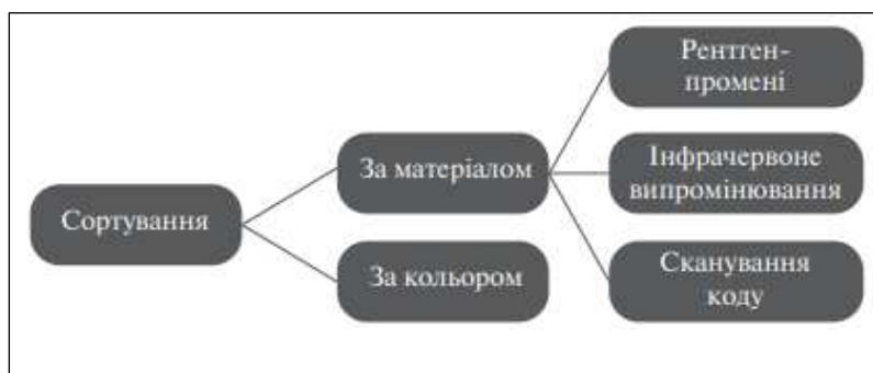
Рис.5.2. Схема автоматизованого сортування полімерних виробів та упаковки.
