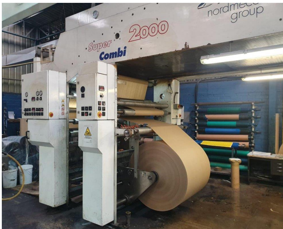
Рис.4.2. Ламінатор SUPER COMBI 2000, Nordmeccanica
