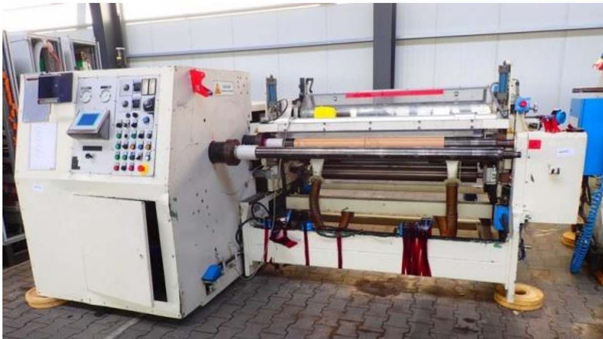
Рис.4.4. Різальна машина компанії КАМРФ SL 104 Z
