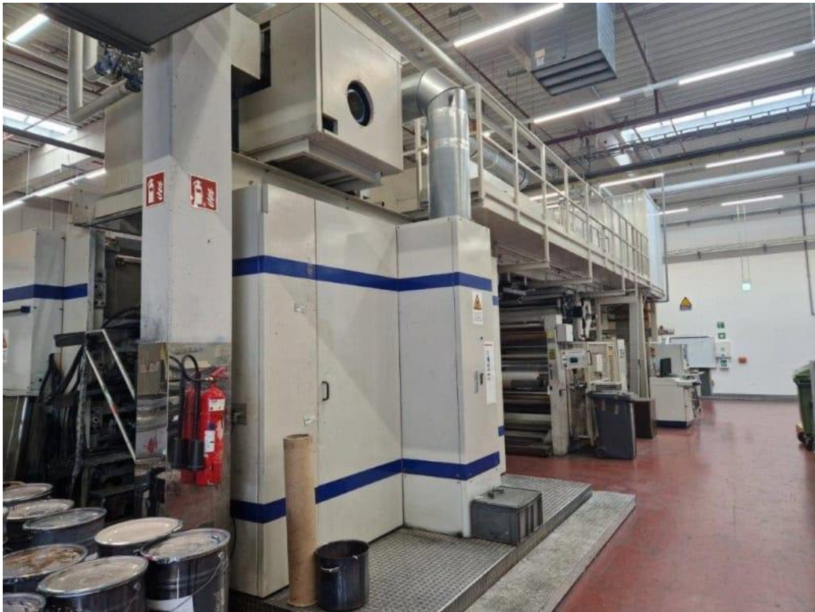
Рис.4.1 Флексографічна друкарська машина друкарська машина F&K 16S F24007.
