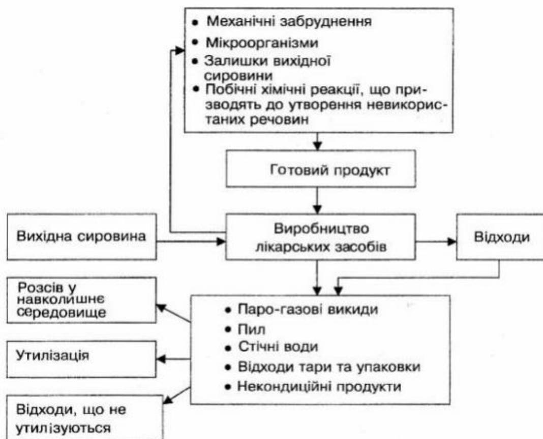
Рисунок 8.1 – Схема організації виробництва лікарських препаратів
