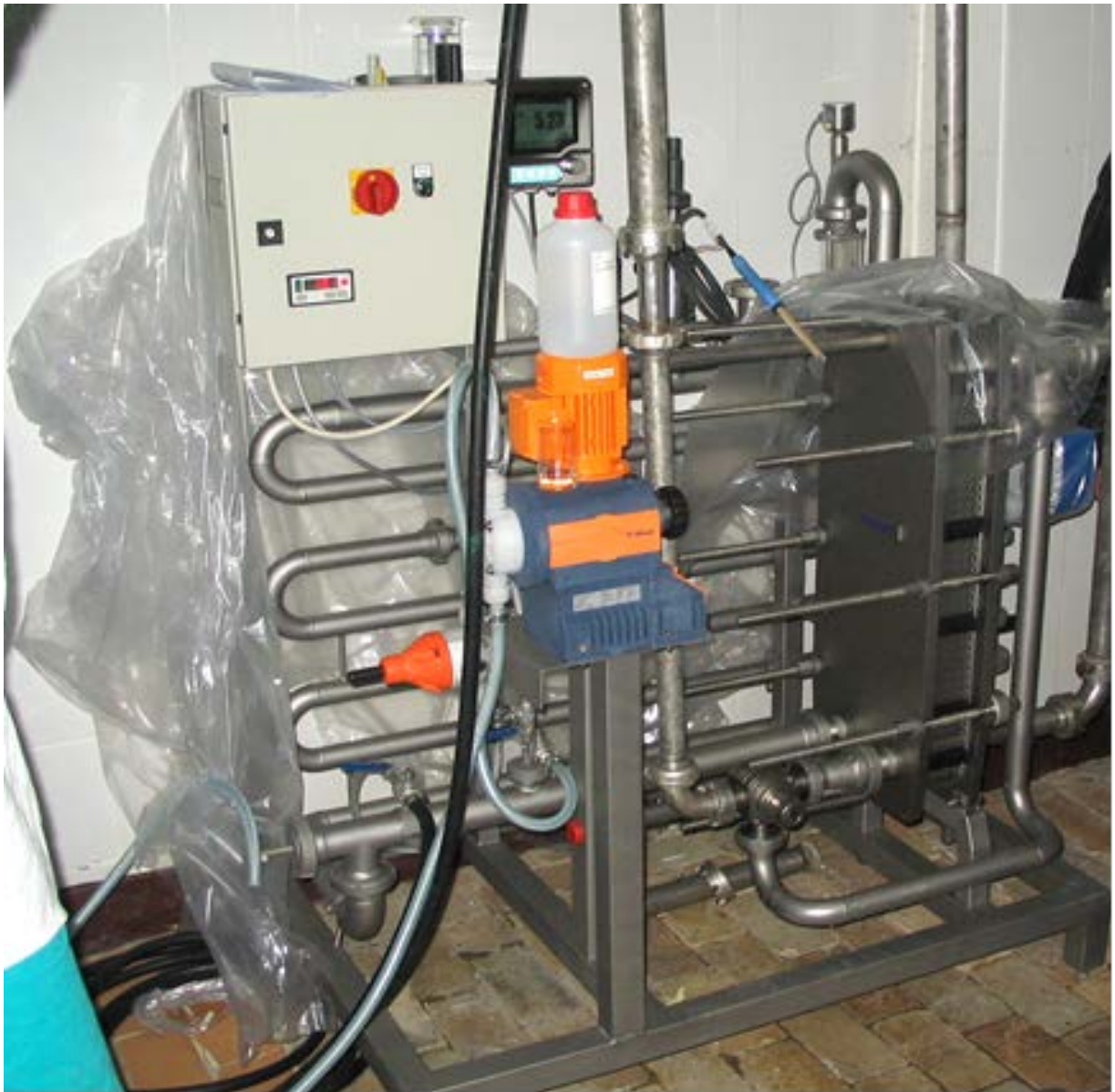
Рис.1.2 Модуль кислотної коагуляції фірми MGL, обладнаний пластинчастим теплообмінником для підігріву знежиреного молока, що відходить сироваткою
