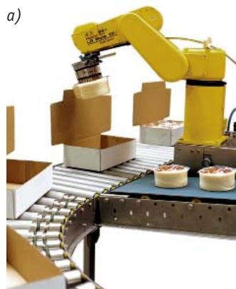
Рис. 5. Технологічні схеми застосування типових РТК для формування групової упаковки (а) і транспортного пакета (б)
