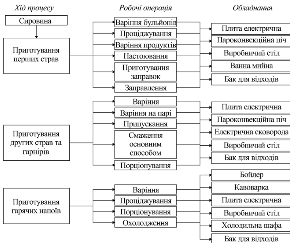
Рис. 3.4 - Структурно-технологічна схема виробничого процесу у гарячому цеху
