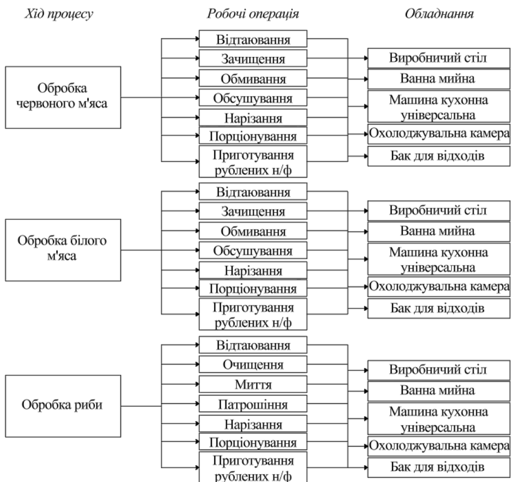
Рис 3.3 - Структурно-технологічна схема виробничого процесу м'ясо-рибного цеху
