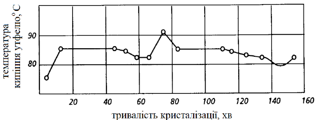
Рис. 1.1 Графік зміни температури кипіння утфелю впродовж процесу кристалізації
