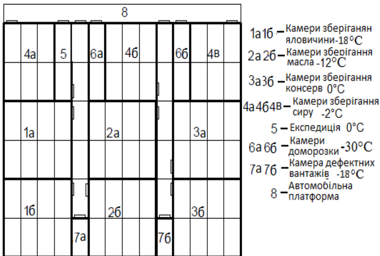
Рис.2.4. Планування камер холодильника .
