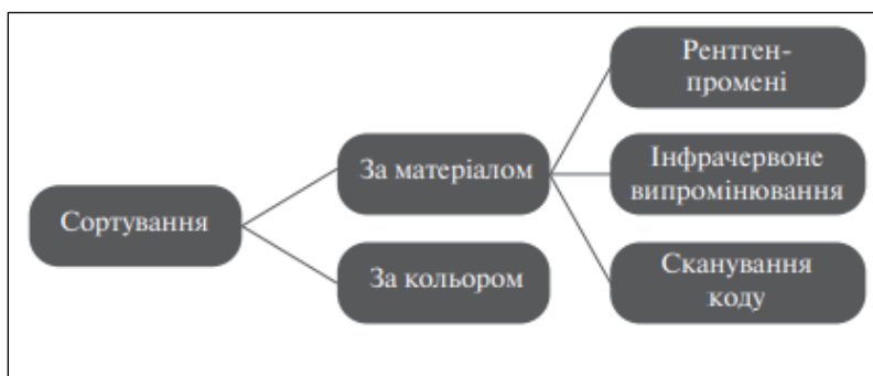
Рис.5.2. Схема автоматизованого сортування полімерних виробів та упаковки.
