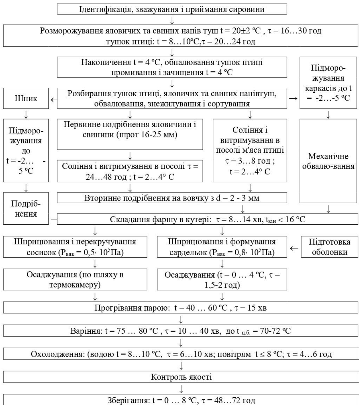
Рис. 2.2. Технологічна схема виробництва сосисок і сарделенок
