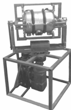
Рис. 1. Загальний вигляд експериментально-дослідного зразка вібровідцентрового дезінтегратора
