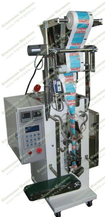
Рисунок 1.4 - Вертикальний пакувальний автомат DXDK-125
