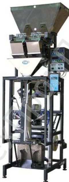
Рисунок 1.3 - Вертикальний пакувальний автомат ТПП-100У
