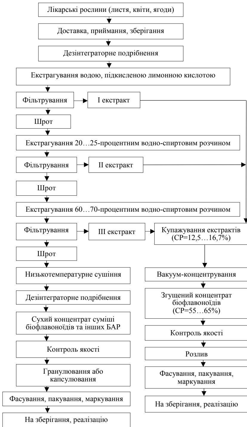
Рис. Принципова технологічна схема отримання сухих і згущених концентратів біофлавоноїдів з лікарської сировини
