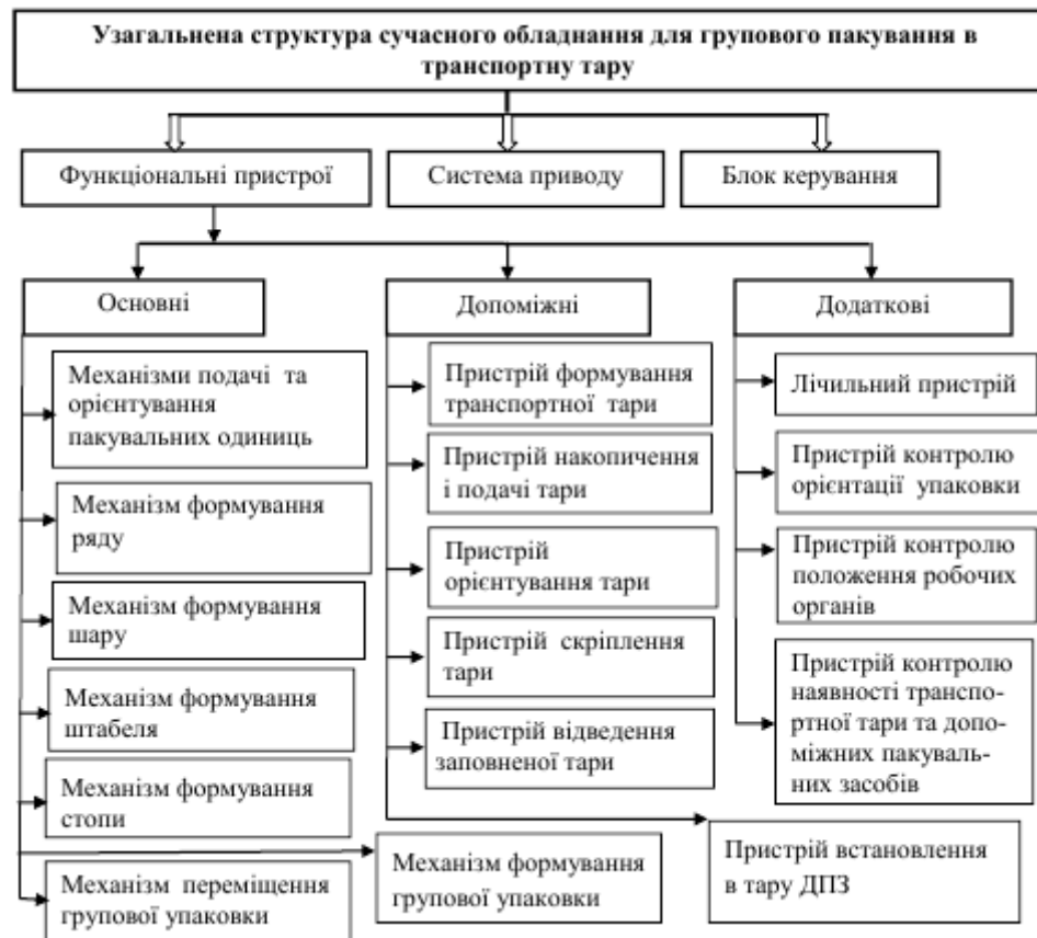
Рис. 1.6. Узагальнена структура обладнання для групового пакування в транспортну тару
