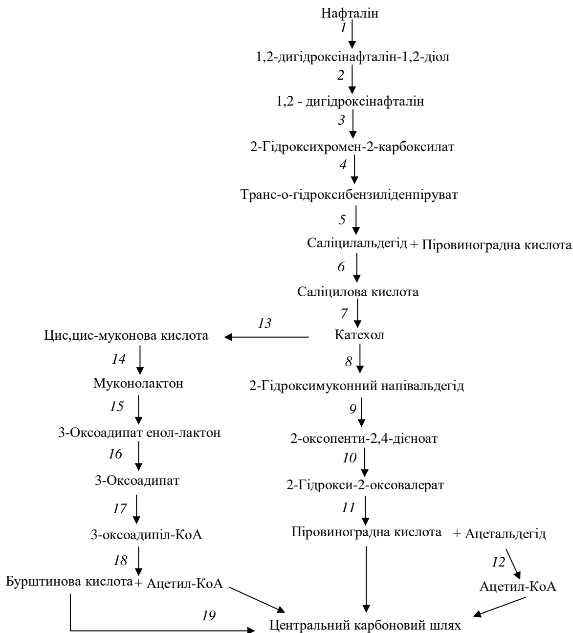
Рис 3.1. Шлях катаболізму нафталіну у Ps. putida NBRC 14164
